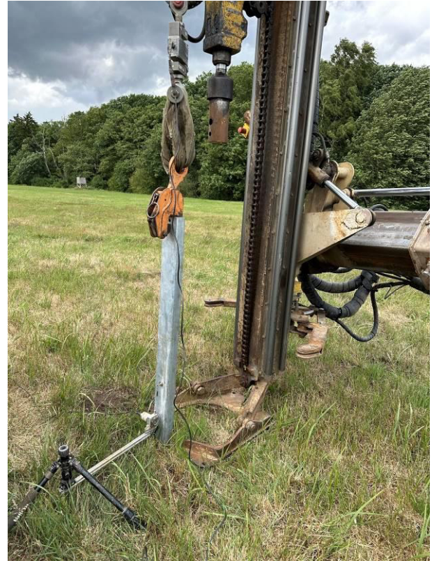
Vorbereitung axialer Zugversuch
